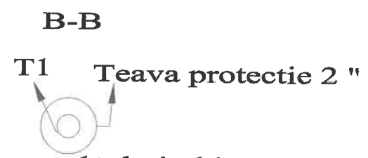
T1-teava trasa 1tol , imbinare prin sudura
